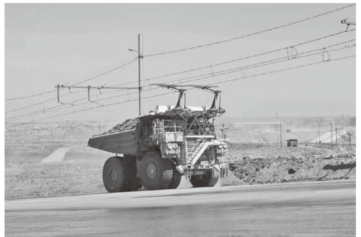
(ザンビアの鉱山で架線を走りながら充電する日立建機のフル電動ダンプトラック)
