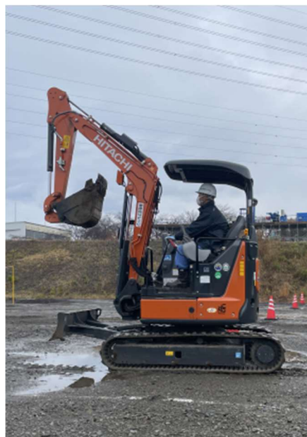
写真-3 油圧ショベルの旋回姿勢 (駐車場入れでの旋回姿勢)
